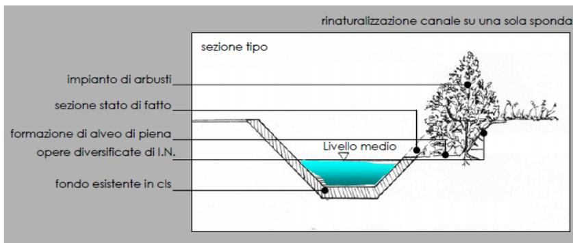
Fig.2 Rinnaturalizzazione di un canale, da " Repertorio delle misure di mitigazione e compensazione paesistico ambientali - Adeguamento Piano Provinciale di Milano".
