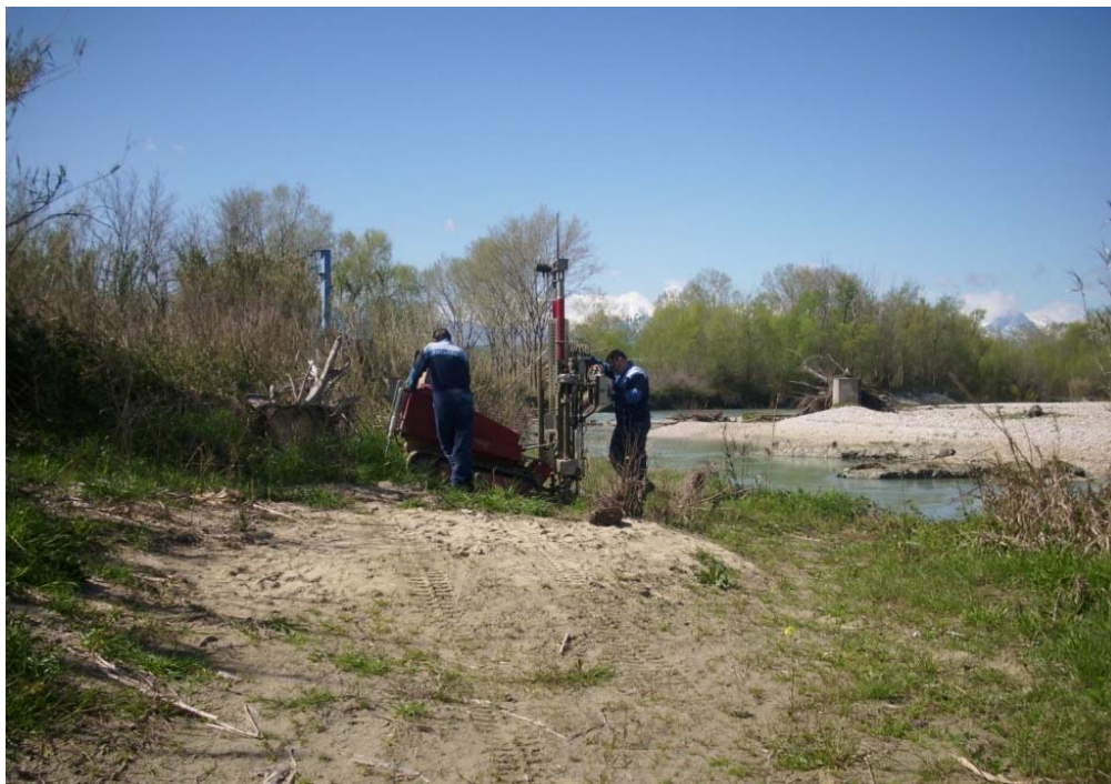
Postazione Prova Penetrometrica: DPSH.1 - Località: Sp dx Fiume Vomano - Depuratore - Pineto (TE)
