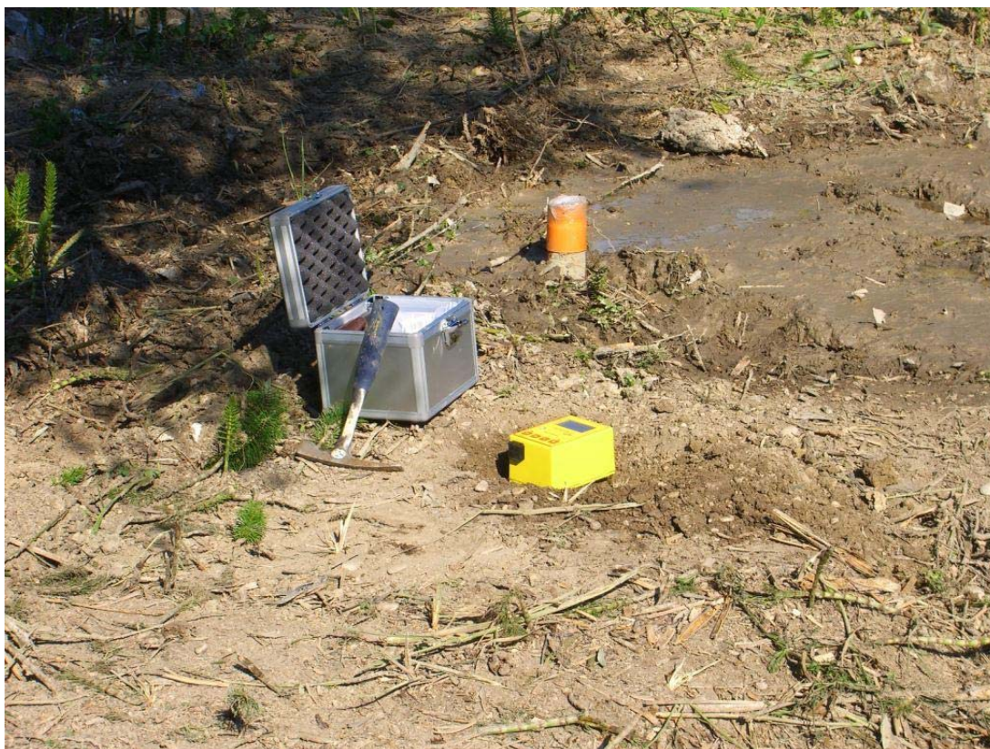
Fig.1 Tromometro digitale mod. Tromino zero (Micromed) sul punto di misura nei pressi del Piezometro S5 - SS 16 Adriatica, Km 423 + V
