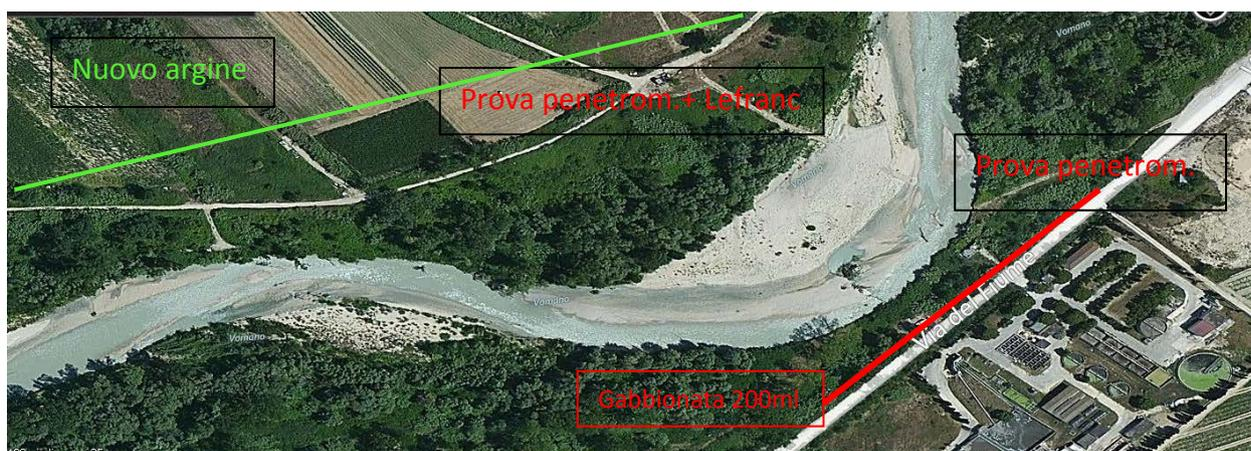
Infine, sulla destra idrografica del Fiume Vomano vi sono tre canali artificiali denominati "Grassetto". Poiché la quota di questi canali è molto più bassa rispetto al livello di piena nell'asta principale, sono state previste quattro valvole di non ritorno (clapet) che bloccheranno temporaneamente l'immissione di questi canali secondari. L'acqua del reticolo minore sarà accumulata temporaneamente in aree di laminazione delimitate da un argine
