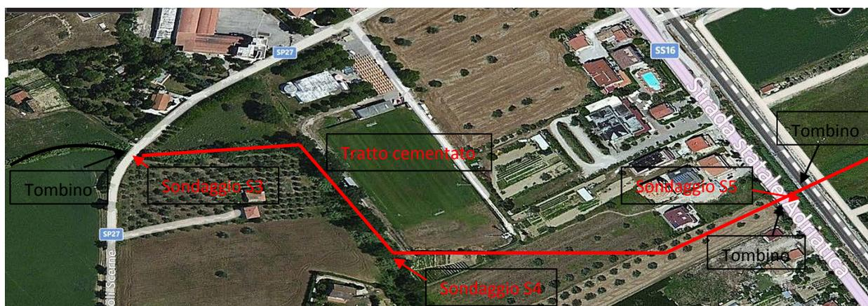
Il percorso originario che corre parallelamente alla linea di costa fino al Torrente Calvano, subito dopo un campo di calcio, viene abbandonato per prendere un canale di nuova realizzazione fino allo sbocco a mare. Vista la differenza di quota, il collegamento tra il vecchio ed il nuovo formale avverrà attraverso uno scivolo di raccordo alla cui base è stato effettuato un sondaggio (S4) dotato di piezometro per conoscere le caratteristiche dei terreni di fondazione.
