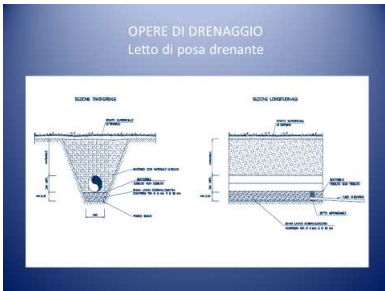
Figura 4 – Standard letto di posa drenante
