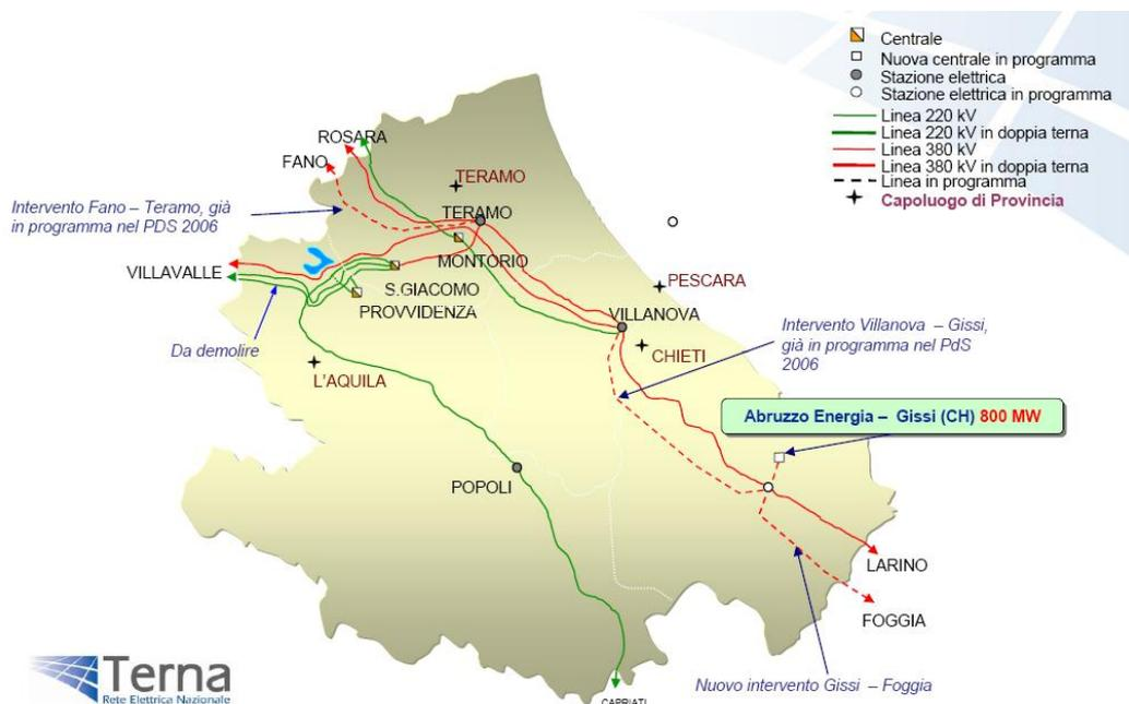
Figura 5.2: Rete elettrica di trasmissione a 380 e 220 kV
